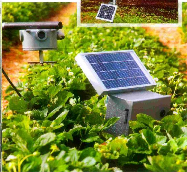
Les capteurs de spores, développée par PhytoData et Agriculture Canada, permettent de détecter si la maladie est présente dans l'air.
