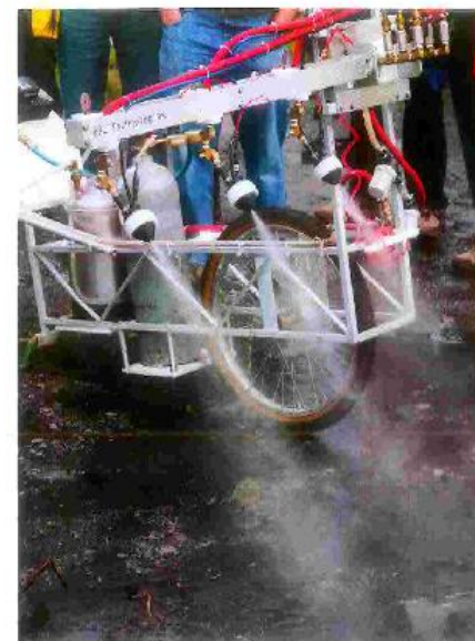
La pulvérisation électrostatique permet d'augmenter la quantité de pesticide déposé sur la plante plutôt que d'être perdu sur le sol.
